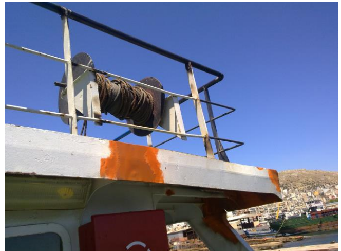
Εικόνες 8,9: Η αποκατάσταση των ζημιών όπως διαπιστώθηκαν μετά την έξοδο του Δ/Ξ ΜΑΝΤΟΥΔΙ από το ναυπηγείο. (αριστερά: της πλήρης εξωτερικά, επάνω: των χειραγωγών του δεξιού τμήματος του καταστρώματος γέφυρας.
