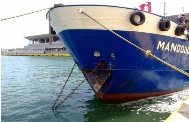
Εικόνες 5,6: Οι ζημιές οι οποίες διαπιστώθηκαν στο Δ/Ξ ΜΑΝΤΟΥΔΙ εξωτερικά (αριστερά: εμπρόσθιο τμήμα, δεξιά: χειραγωγό δεξιού καταστρώματος γέφυρας)
