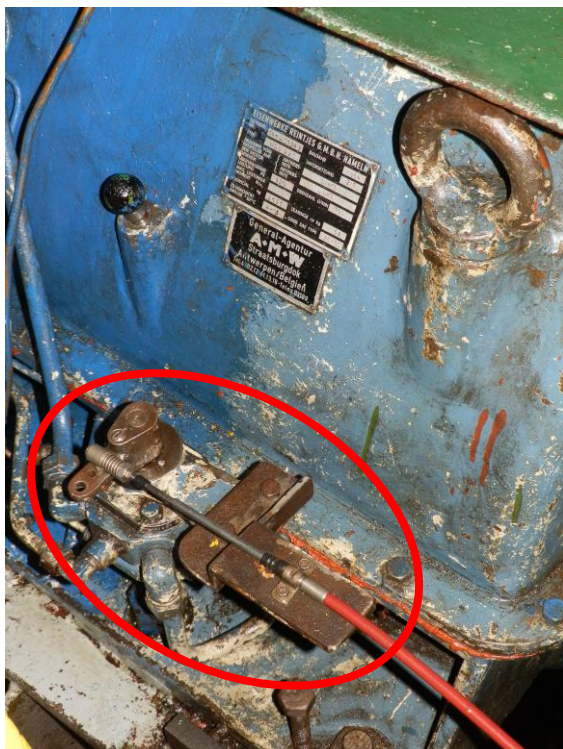
Εικόνες 15,16: Η κατάληξη των συρματοσχοινων ελέγχου (αριστερά) στον αναστροφέα και (άνω) στον ρυθμιστή στροφών της κύριας μηχανής.
