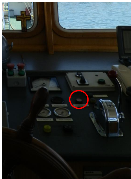
Εικόνα 17: Το κομβίο που φέρει την ένδειξη «ΚΟΥΔΟΥΝΙ ΑΝΑΓΚΗΣ ΡΕΒΕΡΣΑΣ», στον πίνακα ελέγχου της γέφυρας, δίπλα στο μοχλό ελέγχου της πρόωσης (εντός κόκκινου κύκλου).
