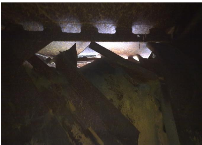
Εικόνα 7: Οι ζημιές οι οποίες διαπιστώθηκαν στο Δ/Ξ ΜΑΝΤΟΥΔΙ εσωτερικά (αριστερά: εντός του F.P.T. , δεξιά: άνωθεν του F.P.T.)
