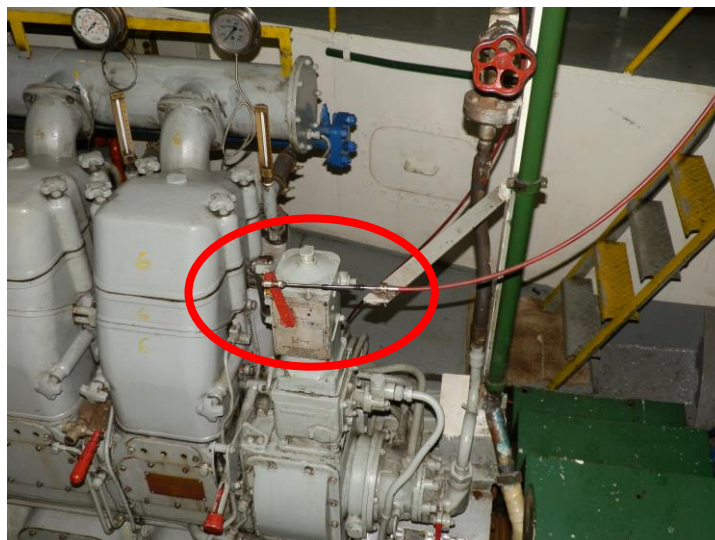
Εικόνες 15,16: Η κατάληξη των συρματοσχοινων ελέγχου (αριστερά) στον αναστροφέα και (άνω) στον ρυθμιστή στροφών της κύριας μηχανής.
